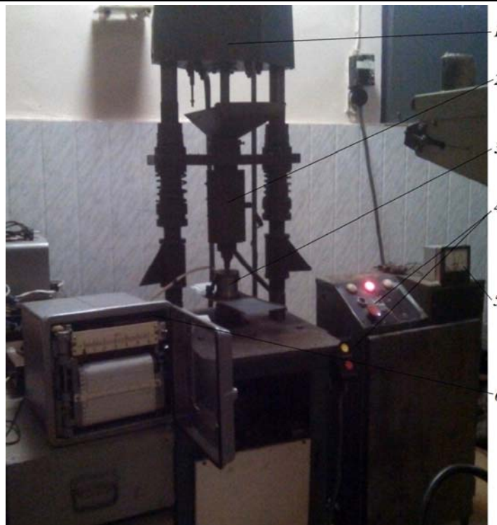
Рис. 2. Експериментальна литвева установка: 1 – литвєвий прєс МЛВ-32; 2 – матерiальний цилiндр; 3 – прєс-форма; 4 – блок керування; 5 – прилад ЭВ для контролю температури; 6 – самопишущий потенцiометр ПС1-04
