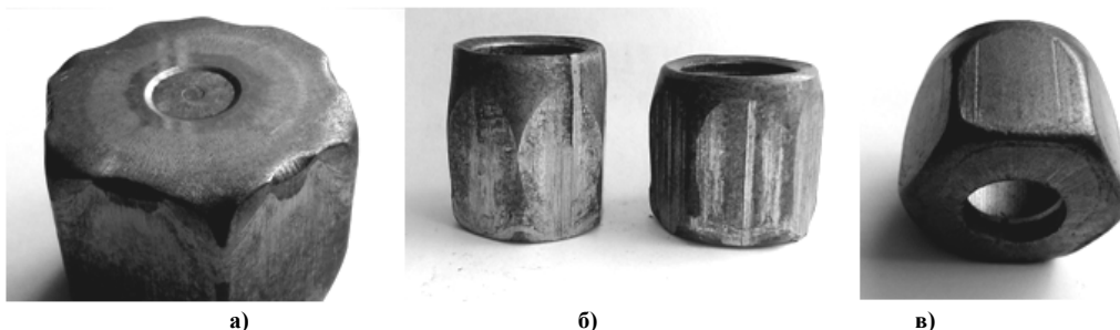
Рис. 2. Поверхневі недоліки заготовки гайки отриманої холодним видавлюванням: а – зариви, утяжини; б – тріщини, шорсткість, в – поздовжні тріщини
