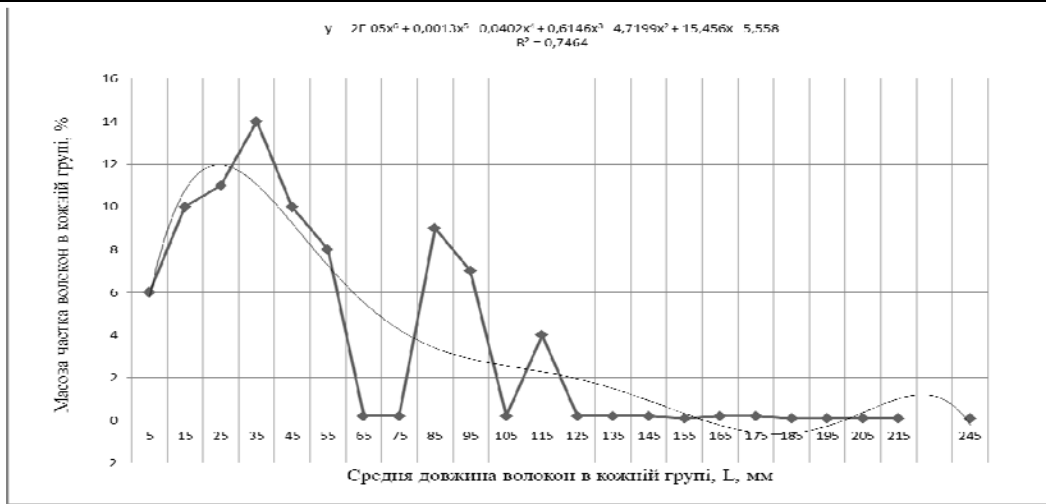
Рис. 6. Діаграма розподілу волокон за довжиною в стеблах трести льону олійного сорту «Орфей» після обробки на лабораторній м'ялці
