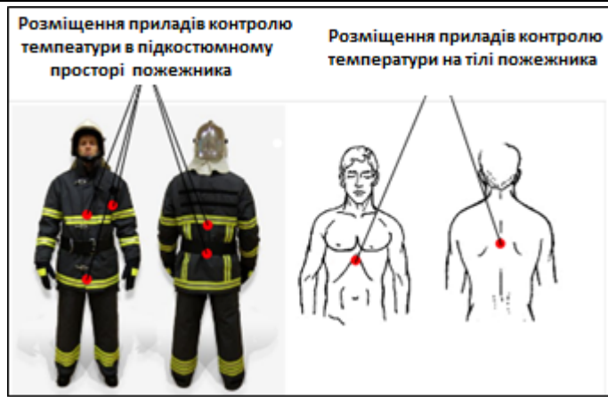
Рис. 6. Схема розміщення датчиків на тілі пожежного і в підкожному просторі
