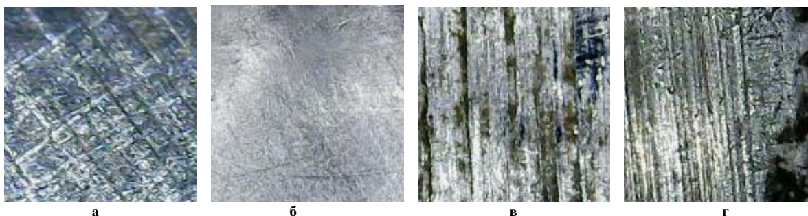
Рис. 4. Фрагменти зношених сферичних поверхонь пальця, X 25
