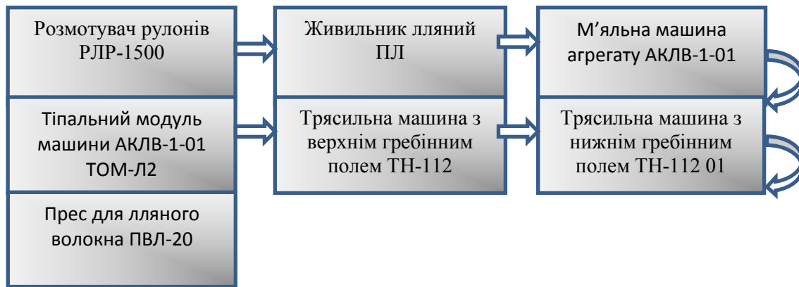
Рис. 3. Сучасна технологічна лінія для отримання очищеного волокна із трести льону олійного
