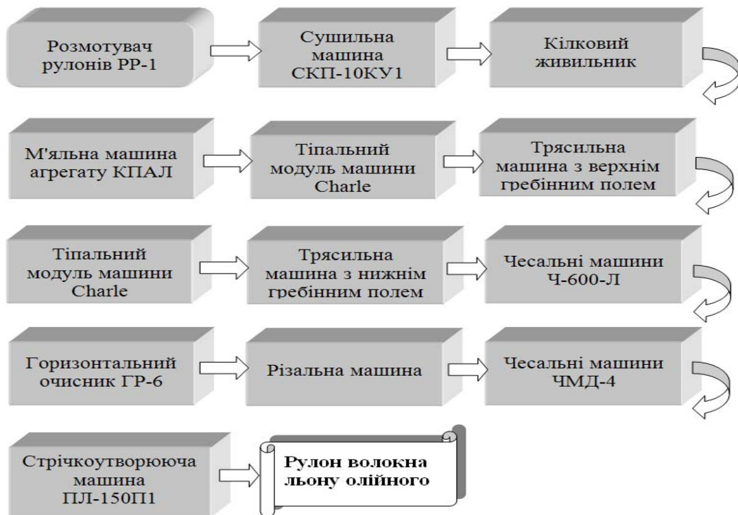
Рис. 1. Технологічна лінія для отримання очищеного волокна із трести льону олійного
