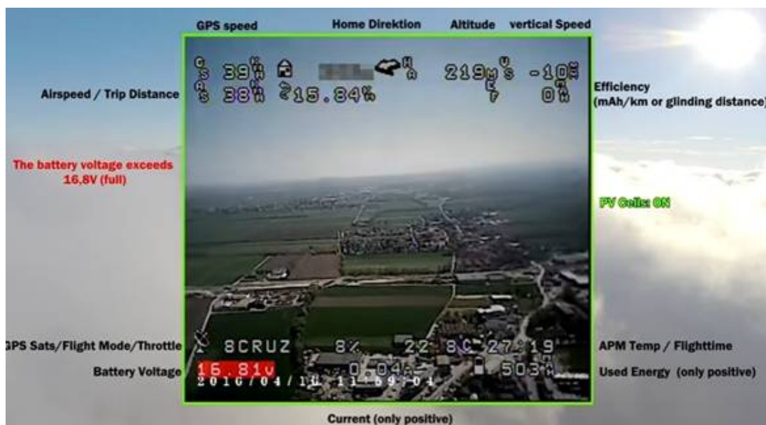
Рис. 3. FPV полет с совмещенной телеметрией.
