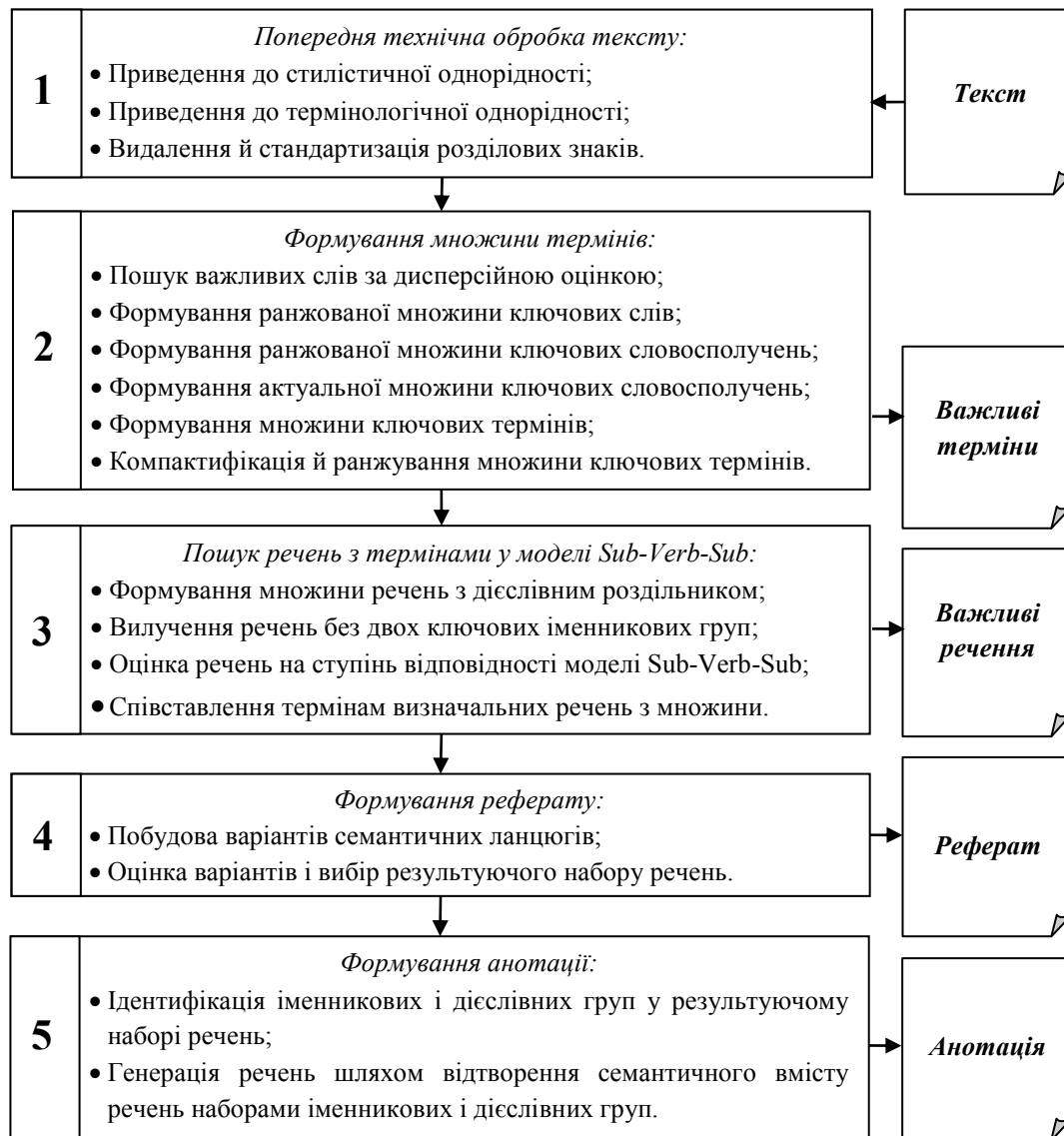
Рис. 4. Схема інформаційної технології автоматизованого формування згорнутих зразків текстових документів
