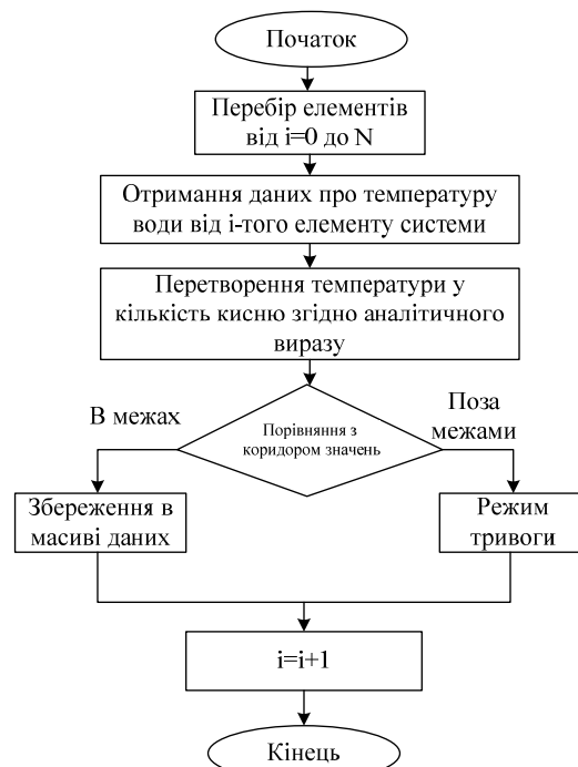
Рис. 3. Алгоритм роботи модуля визначення рівню кисню в воді
