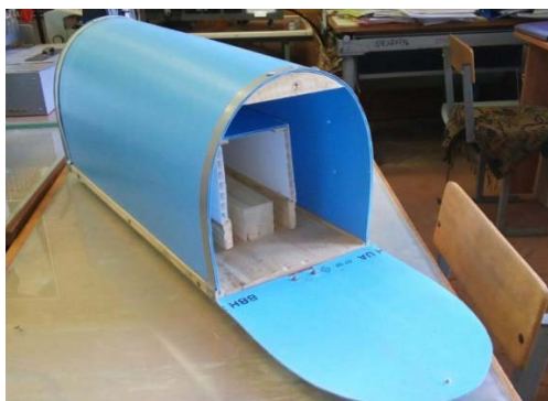
Рис. 4. Установка для вимірювання паропроникності текстильних матеріалів
