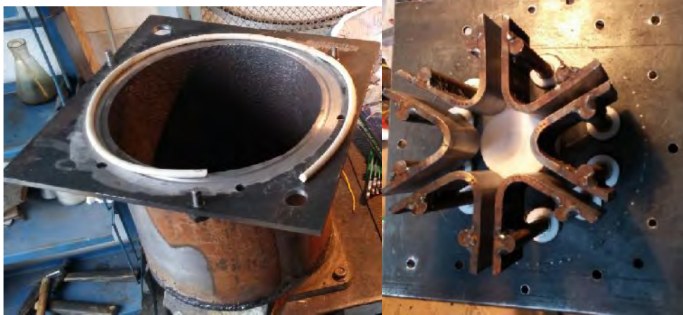
Рис. 3. Загальний вид корпусу котла на 35 кВт
