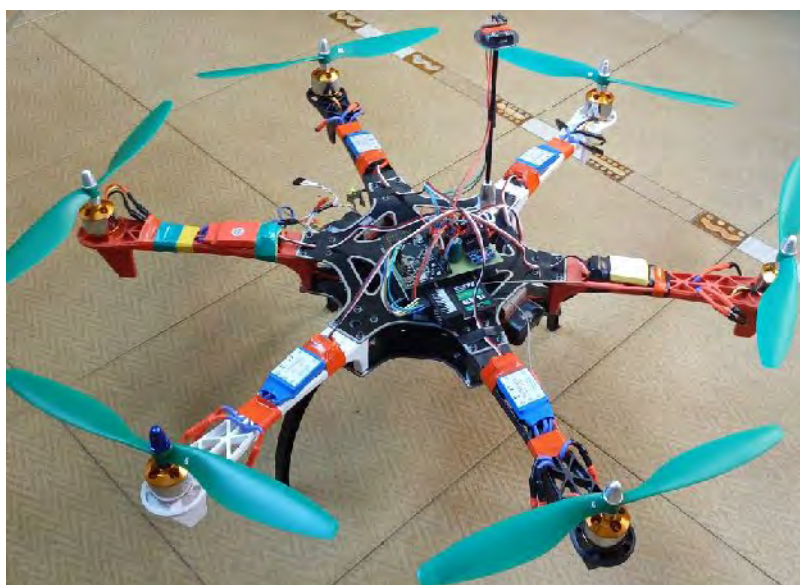
Рис.13. Фото спроектированного гексакоптера на базе Arduino mega2560
