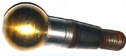
Рис. 5. Загальний вигляд зразка кульового пальця, на НСП якого нанесено шар латуні Л63
