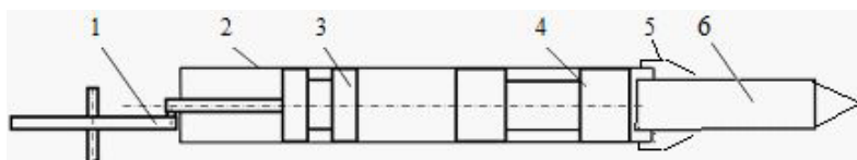
Рис. 1. Схема ударного механізму з електричним приводом: 1 – кривошип; 2 – гільза; 3 – поршень; 4 – бойок; 5 – патрон; 6 – інструмент
