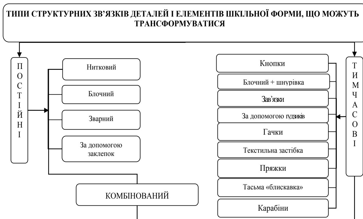
Рис. 2. Схема типів та видів структурних зв'язків деталей і елементів форменого одягу для дітей, що підлягають трансформації
