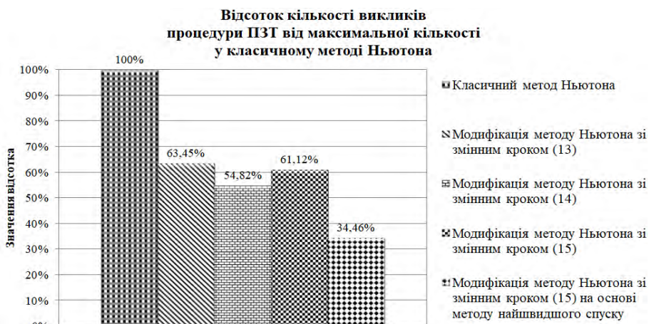
Рис. 5. Порівняльний аналіз розглянутих методів на поставленій задачі за критерієм кількості викликів процедури розв'язку ПЗТ з нульовим наближенням до початкової умови
