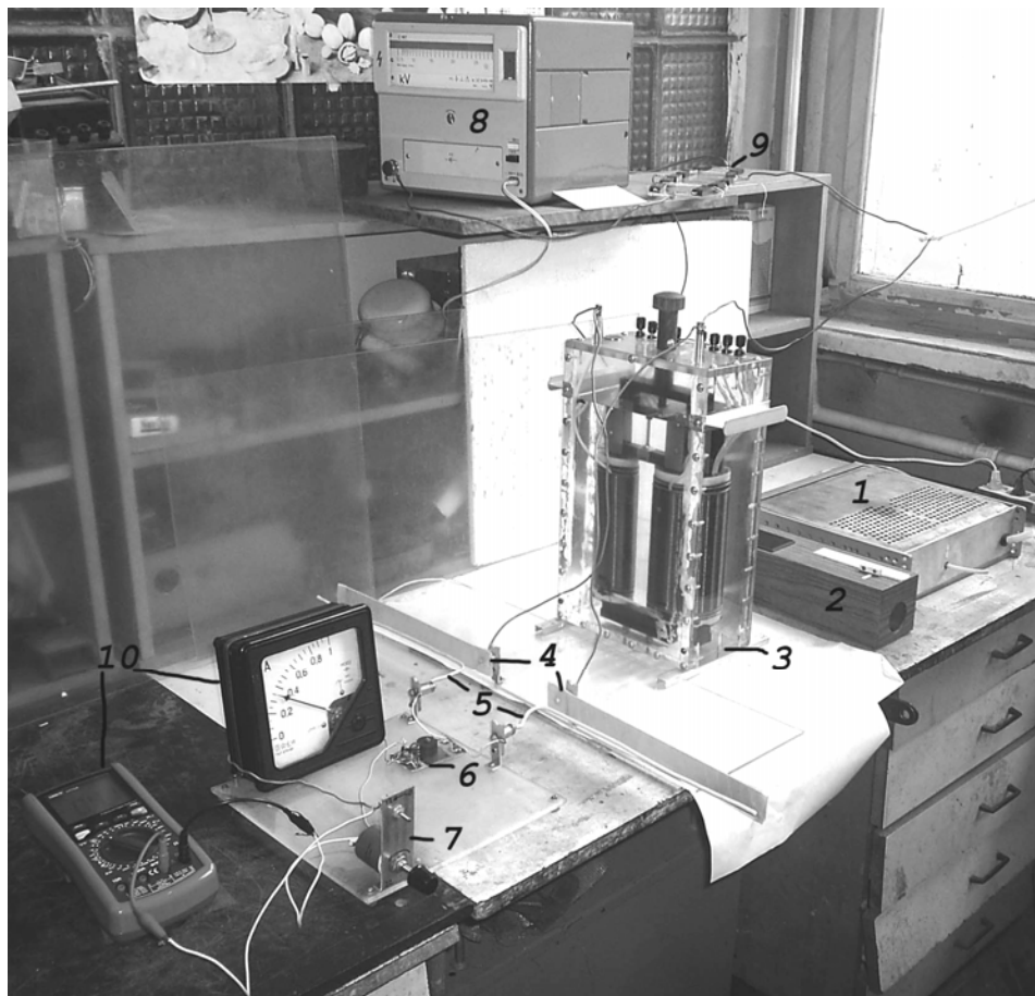
Рис. 1. Експериментальна установка для зняття характеристик теслівських процесів при безконтактній підзарядці акумуляторів імплантованих електроприладів:
