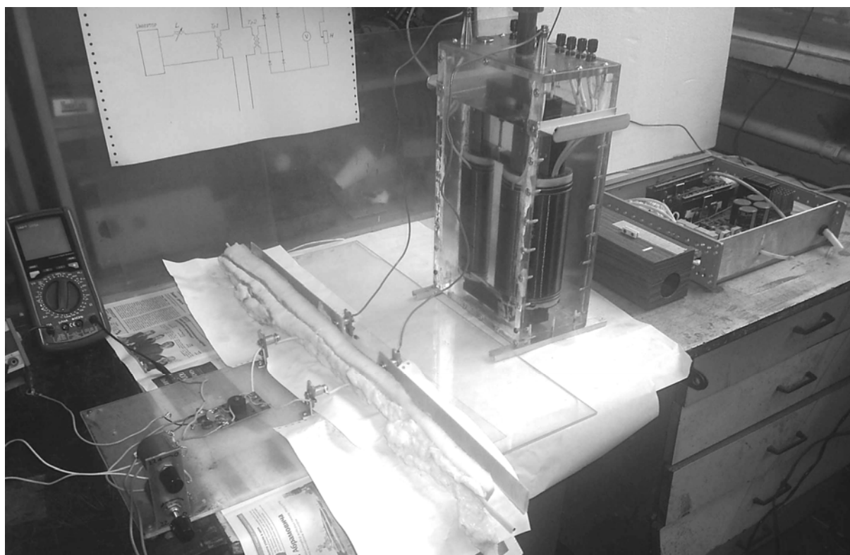
Рис. 6. Передача енергії без проводів через органічне середовище
