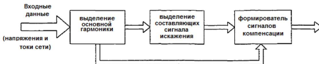
Рис. 3. Структурная схема предлагаемого АФ
