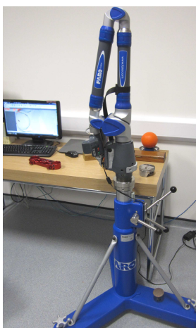
Рис. 2. Сканування верхньої траверзи: а – 3D-сканер FARO Laser Scan Arm; б – процес сканування
