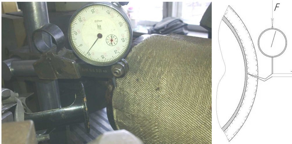
Рис. 6. Визначення сили протидії повстини деформації голки
