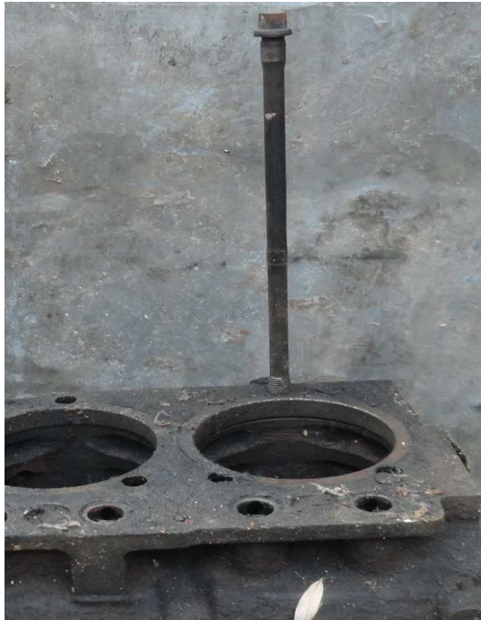
Рис. 4. Місце встановлення болта кріплення в картер двигуна
