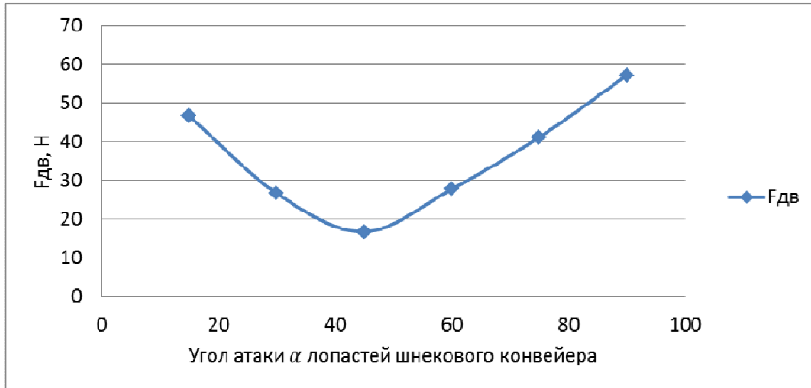
Рис. 4. Залежність рушійної сили від кута атаки лопастей
