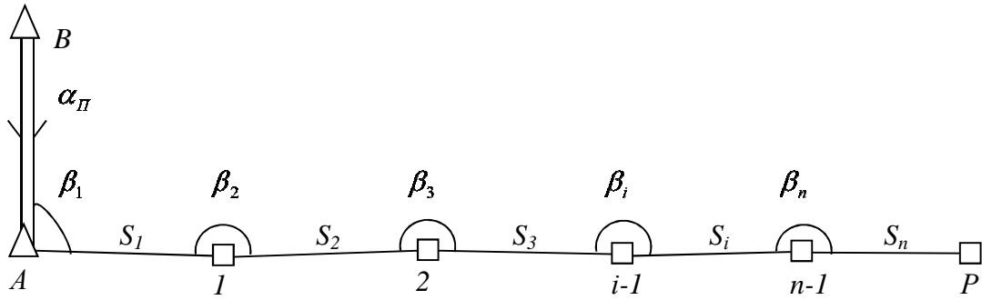
Рис. 2. Зустрічний хід з виміряними елементами
