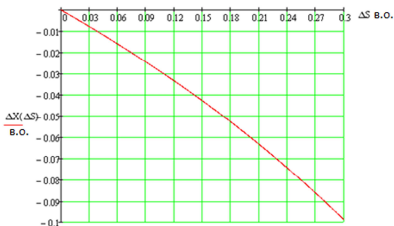
Рис. 6. Залежність зміни величини індуктивного опору проводів ПЛ від зміни поперечного перерізу
