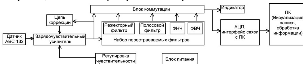
Рис. 1. Блок-схема аппаратных средств снятия и обработки вибрационных сигналов
