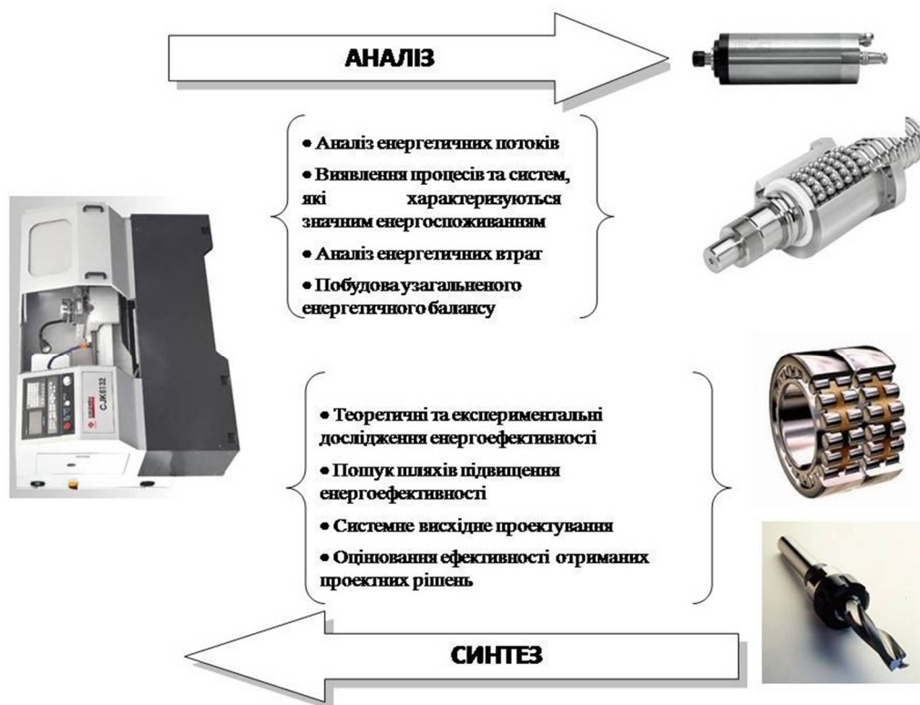
Рис. 1. Методологія дослідження енергоефективності верстатів
