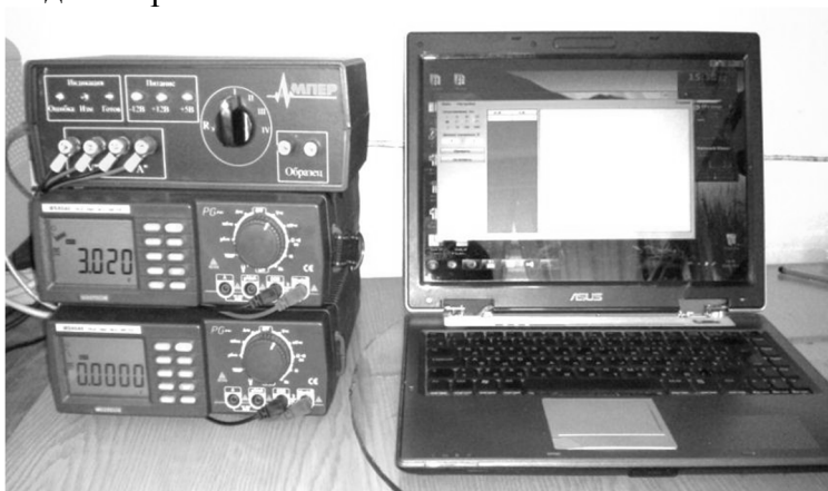
Рис. 2. Внешний вид разработанного измерительного комплекса для проведения исследований вольтамперных характеристик
