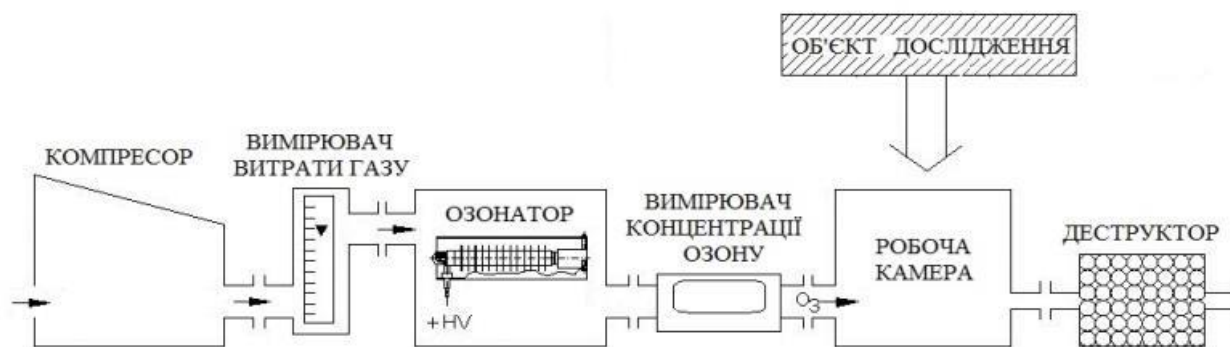
Рис. 1. Структурна схема функціональних блоків лабораторного станду “Ozone-agro 1 L”
