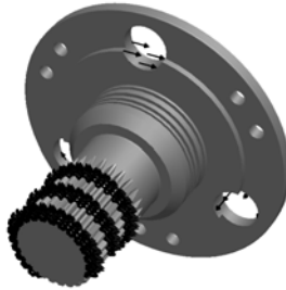
Рис. 5 – 3D-модель рассчитываемого звена ГОМТ с обозначением нагрузок и закреплений
