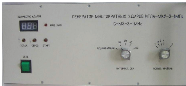
Рисунок 3 – Передняя панель генератора ИГЛА-МКУ-3-1 МГц
