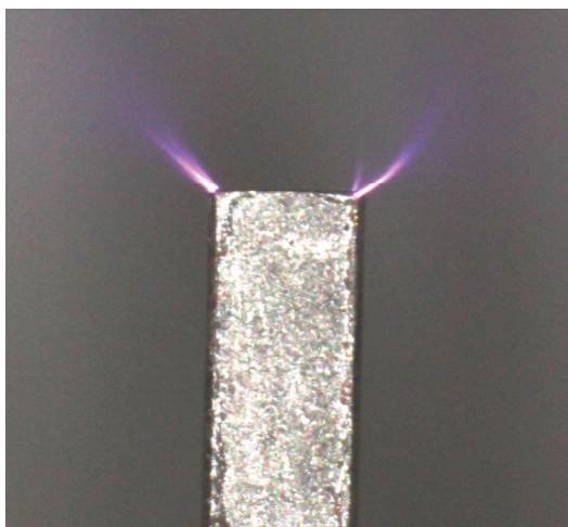
Рисунок 2 – Стримерная корона со стержня квадратного сечения
