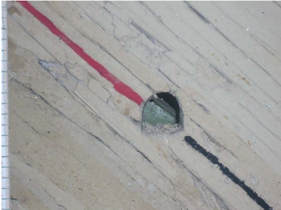
Рис. 2. Сдвигение боковых пород в окрестности штрека при охране широкой податливой опорой
