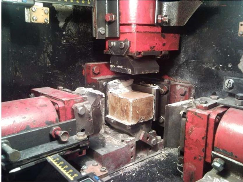
Рис. 2. Образец НРС после разрушения в объемном неравнокомпонентном поле напряжений
