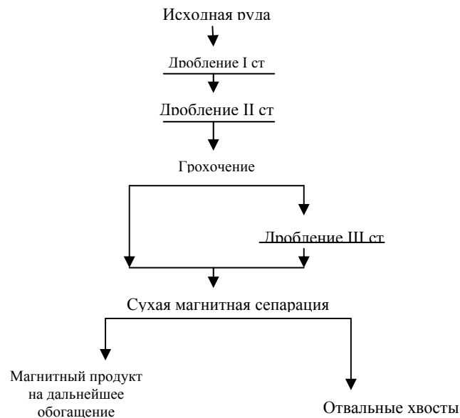
Рис. 1. Схема подготовки руды к обогащению
