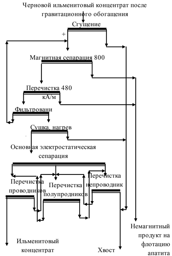
Рис. 3. Технологический блок получения ильменитового концентрата
