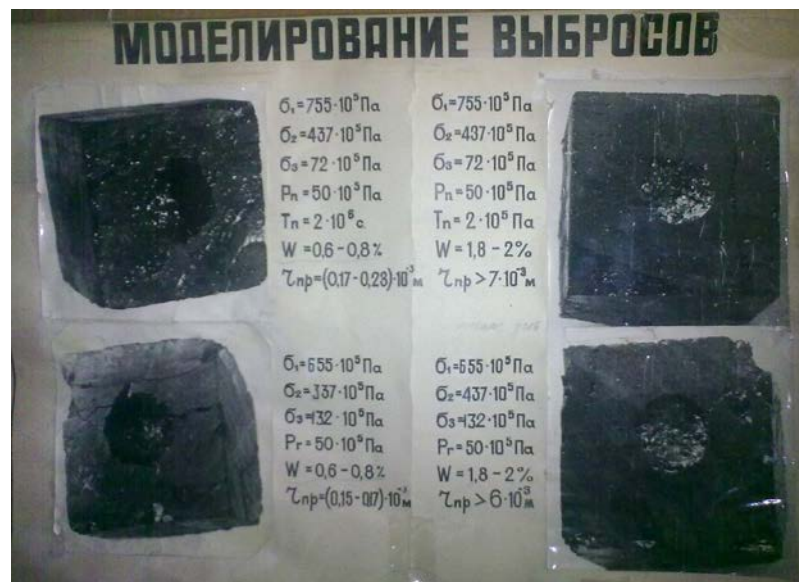
Рис. 2. Характер разрушения угля при моделировании выбросов.
