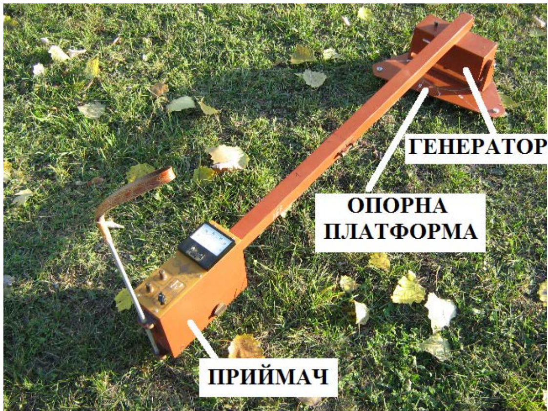
Рис. 1. Прилад ЕФА для виконання робіт методом СГДК-А
