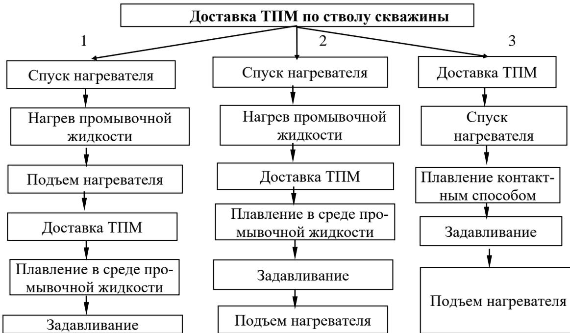
**Рис. 1.** Технология изоляции поглощающих горизонтов при доставке ТПМ по стволу скважины
