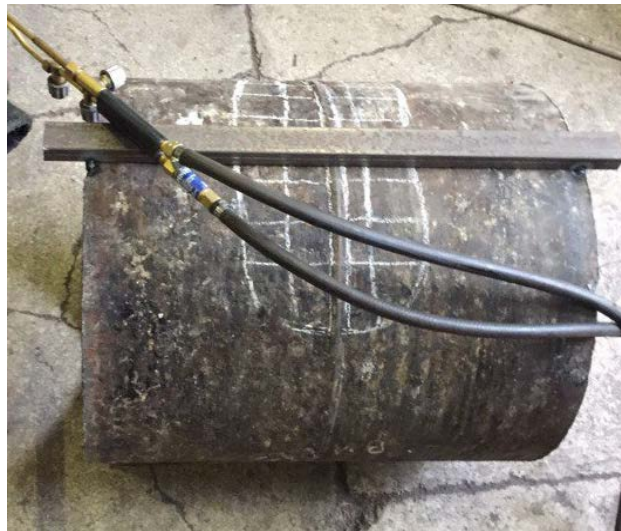
Рис. 1. Котушка із дефектними ділянками для вирізання зразків
