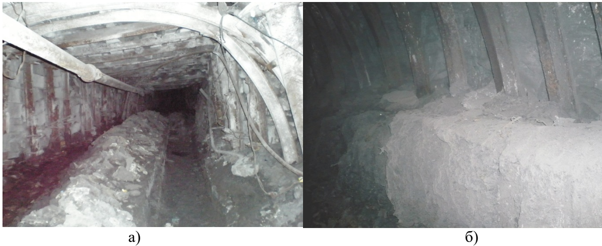
Рис.2. Перерізи порід підшви при веденні підрибок відбійним молотком а) 10 збійка конвеєрного і грузового похилу пл. к 8 ш. ім. Димитрова (2015 р.); б) квершлаг на пл. с 18 ДП «Південно Донбаська №1» (2017р.)
