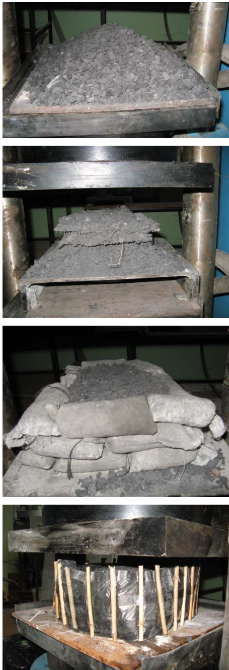
Рис. 7. Загальний вигляд моделей породних конструкцій перед відпрацюванням
