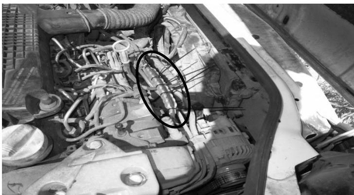
**Рис. 6. Установленный магнитный активатор на (*Renault Kangoo 1.5 dCi*)**
