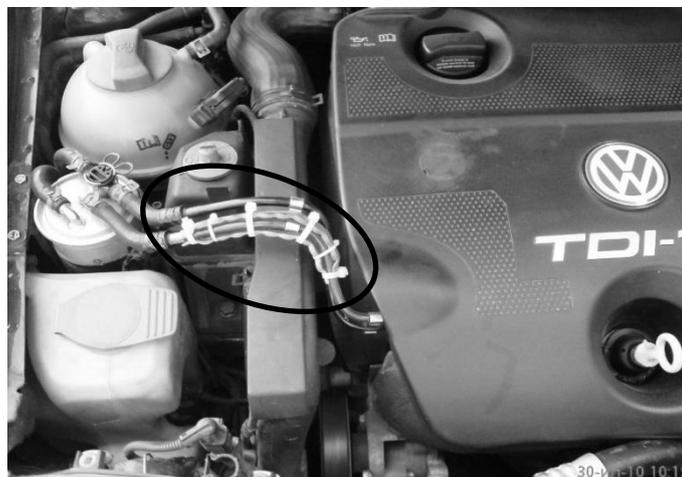
Рис. 5. Установленный магнитный активатор на (Volkswagen Golf Variant 1.9 TDI)
