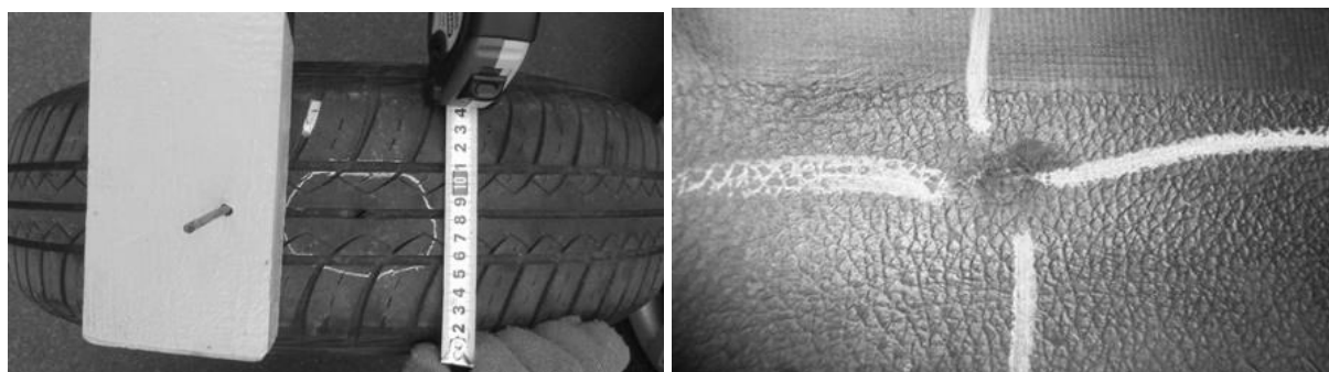
Рис. 6. Отверстие в автомобильной шине, созданное гвоздем \varnothing 3,5 мм
