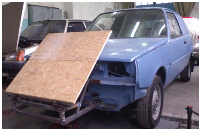
Рис.2. Автомобиль, оборудованный подвижной имитационной моделью капота
