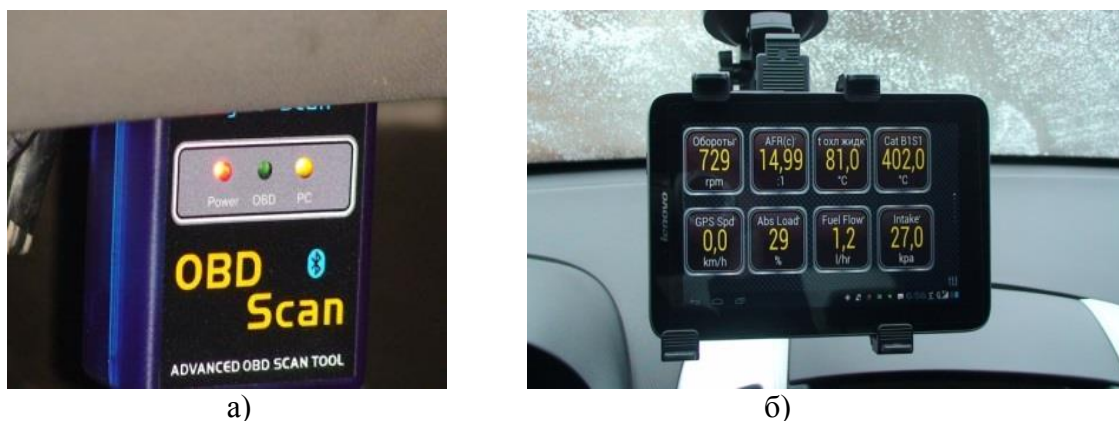
а) диагностический OBD сканер; б) планшет-монитор диагностического комплекса
