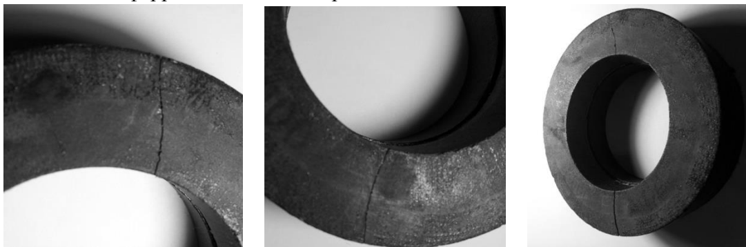
Рис. 2. Ферритный тороидальный магнитопровод, разрушенный магнестрикционным эффектом
