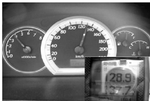
Рис.6. Градуировка спидометра с помощью GPS навигатора
