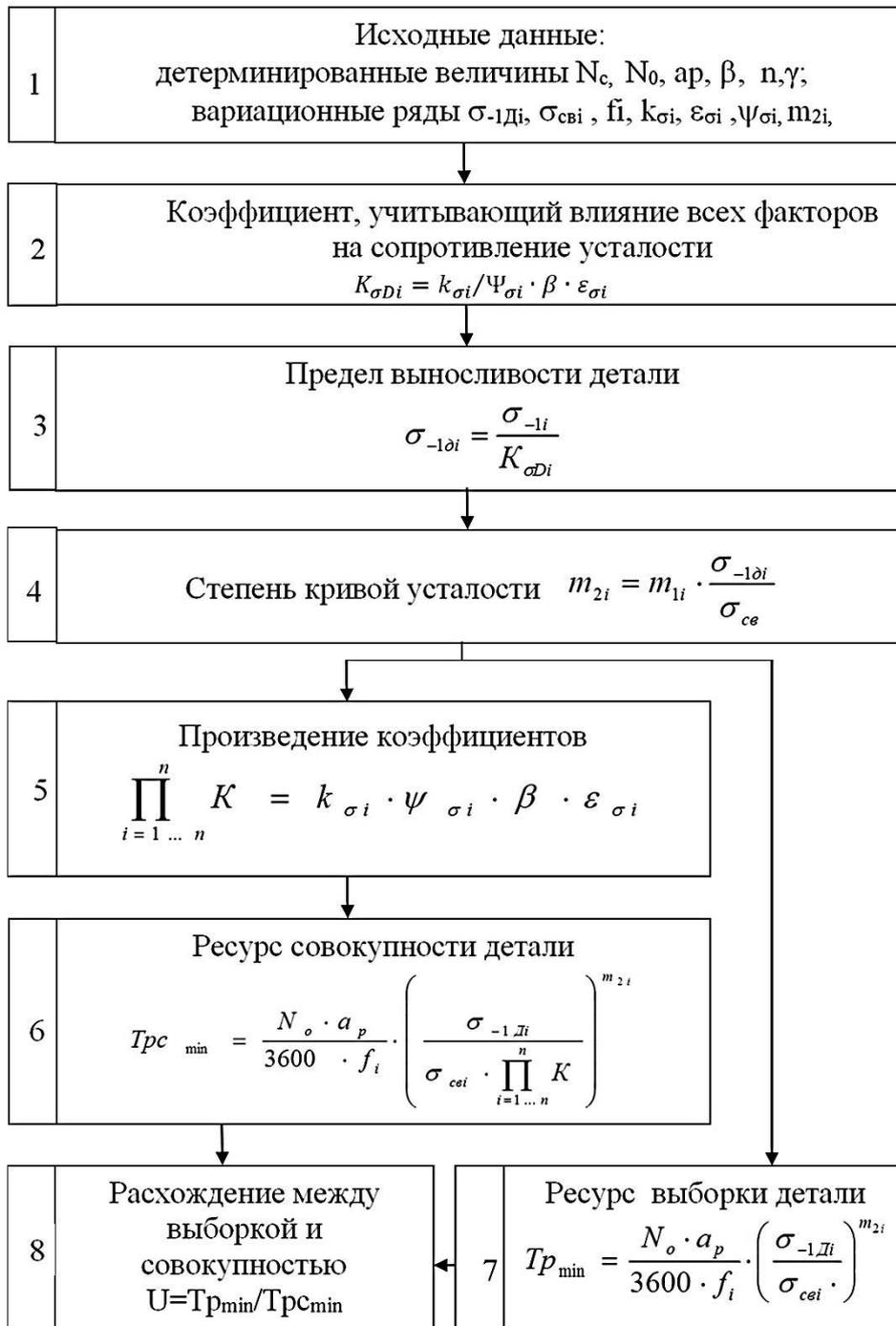
**Рис. 4.** Алгоритм определения упрощенного расхождения между минимальными ресурсами по выборке и совокупности
