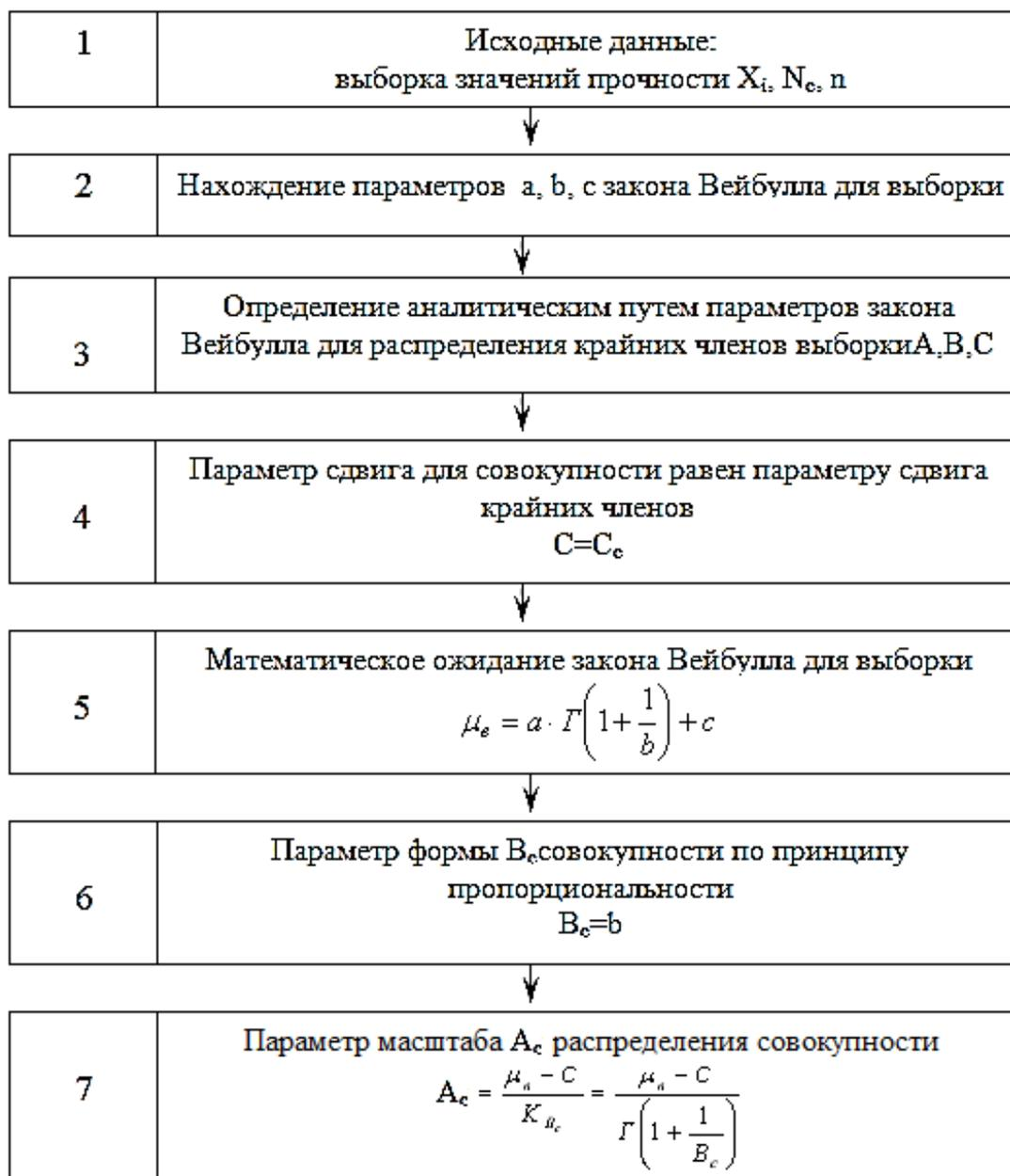
**Рис. 3. Алгоритм расчета распределения Вейбулла по выборочным исходным данным для параметров совокупности**
