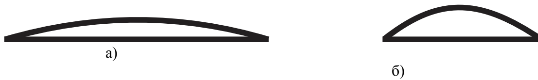
а) основная распространенная (материал: пластик и резина); б) требующая согласования (материал: асфальтобетон, бетон, брусчатка и пр.)
