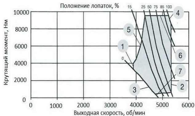
Рис. 7. Рабочая характеристика гидромуфты Vogeson
