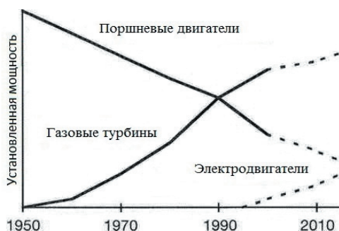
Рис. 1. Приводные машины для центробежных турбокомпрессоров на НПЗ
