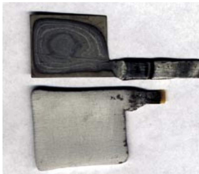
Рисунок 10. Сканированные катод (внизу) и анод (сверху) после 40 часов работы в борфтористоводородном электролите.
